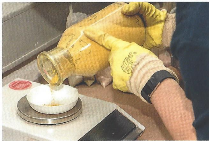
Abb. 6: Wenn sich die gewünschte Farbigkeit des Mörtels nicht über die Sande erzielen lässt, kommen Farbpigmente zum Einsatz
