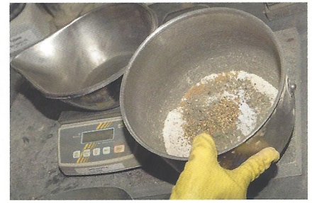
Abb. 5: Im Labor wird zunächst mit kleinen Mörtelmengen gearbeitet, bis die passende Mischung vorliegt
