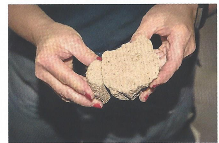
Abb. 14: Das gewünschte Endergebnis: die Probe und der Mörtelkuchen stimmen in Farbigkeit und Körnung überein.
