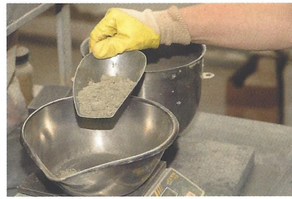
Abb. 4: Zutaten wie Bindemittel, Sande, Zuschläge und Farbpigmente müssen genau abgemessen werden
