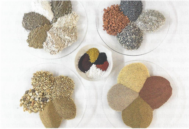
Abb. 15: Mörtelzutaten (von links oben im Uhrzeigersinn): Bindemittel, Zuschläge, Sande aus Fremd- und Eigenproduktion. In der Mitte die Farbpigmente.
