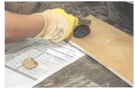
Abb. 11: Das Ergebnis ist ein Mörtelkuchen, der nun noch trocknen muss
